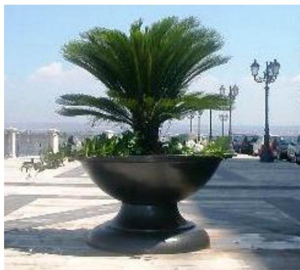
**FIORIERA COMPOSTA DA DUE FUSIONI REALIZZATA IN GHISA GRIGIA LAMELLARE PERLITICA UNI EN1563-GJL250 COSTITUITA DA UN ELEMENTO CONCAVO AVENTE DIAMETRO mm1600 E DA UN ELEMENTO DI SOSTEGNO ALLA FIORIERA NON FISSO CHE PERMETTE IL SUO POSIZIONAMENTO ANCHE IN PERCORSI INCLINATI DOTATO DI UN FORO CENTRALE PER L'OPPORTUNO DEFLUSSO DEI LIQUIDI. VERNICIATURA FERROMICACEA ANTIRUGGINE**
